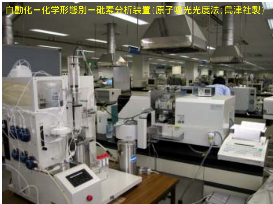
図 32 化学形態別の砒素の分析装置 (島津製作所製 : 2002 年完成)
