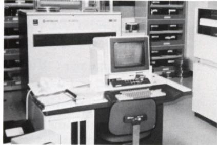
当研究所では、1978年1月から、HITAC M-150システムを導入し、現在は HITAC M-240Dシステムが稼働しています。内部メモリー12MB、ディスク容量5GB、12インチ光ディスク2ドライブ、磁気テープ3デッキ、フロッピーディスク2ドライブがあります。入力にはパンチ/マークカード、TSS端末、パーソナルコンピュータが使えます。出力のためにはラインプリンタの他に漢字プリンタが2台ありますが、これを使用して、大きさも形も様々なAA諸言語の文字を印刷できるようなソフトウェアが開発されていて、国内外の研究者に利用されています。
